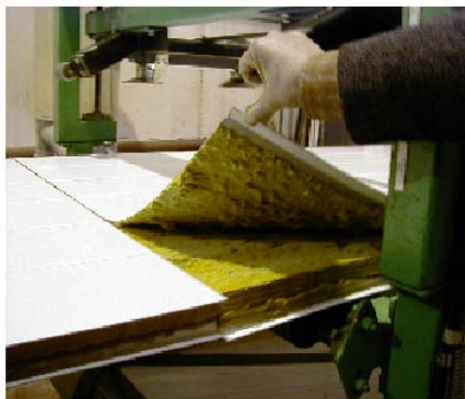
Нарушение слоя минеральной ваты при отслаивании стального листа в процессе изготовления панели.
